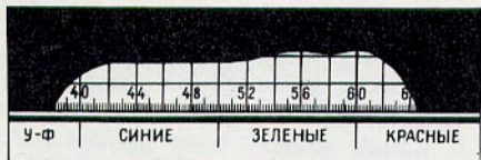
Спектральная светочувствительность при источнике света 5000° К.
