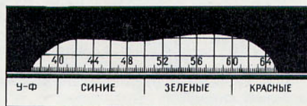
Спектральная светочувствительность при источнике света 5000° К.
