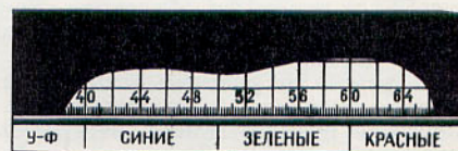
Спектральная светочувствительность при источнике света 5000° К.
