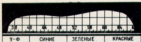
Спектральная светочувствительность при источнике света 2850°К.
